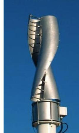
Éolienne à axe vertical de type Savonius
